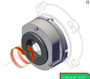
CONNECT THE BRAKE TO POWER SUPPLY AT MOTOR CONNECTION BOX AND TEST BRAKE FUNCTIONING
